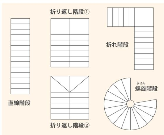
また、階段スペースを計算するためには「階高（かいだか）」を「蹴上（けあげ）」の寸法で割り、「踏面（ふみづら）」の寸法を決定して平面上の長さを算出します。蹴上と踏面の寸法は建築基準法で制限がありますが、これは安全に昇降できるギリギリの急勾配寸法です。実際には間取りの中で調整をしながら緩やかに安全に上り下りできるよう蹴上を低く踏面を広くとっていきます。
